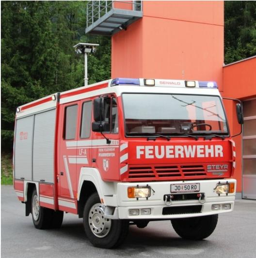
Taktische Bezeichnung: LFA (Löschfahrzeug mit Allrad)
